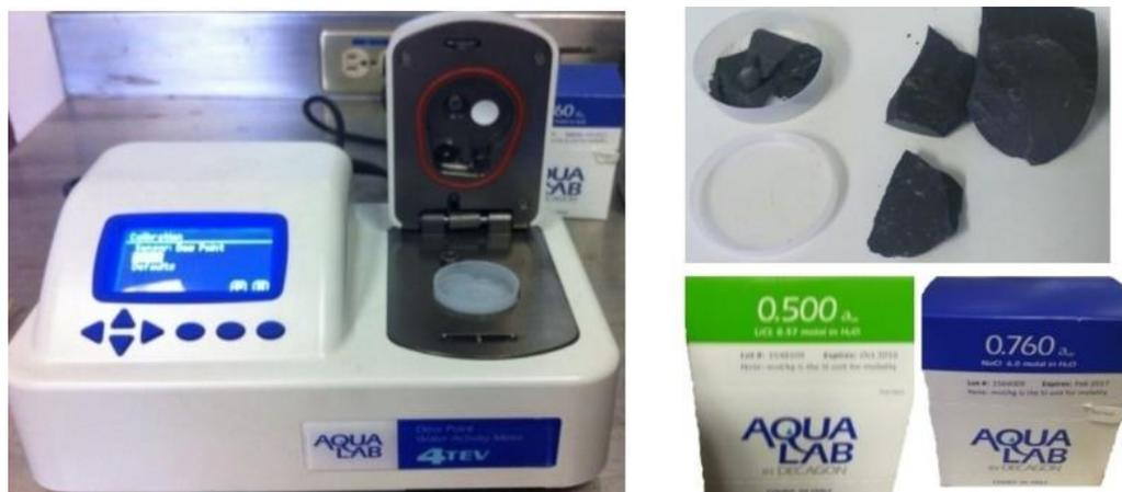
**Figura 1. Equipo para medición de actividad (izq.), muestra de núcleo P1 (arriba) y estándares de calibración (abajo).**
